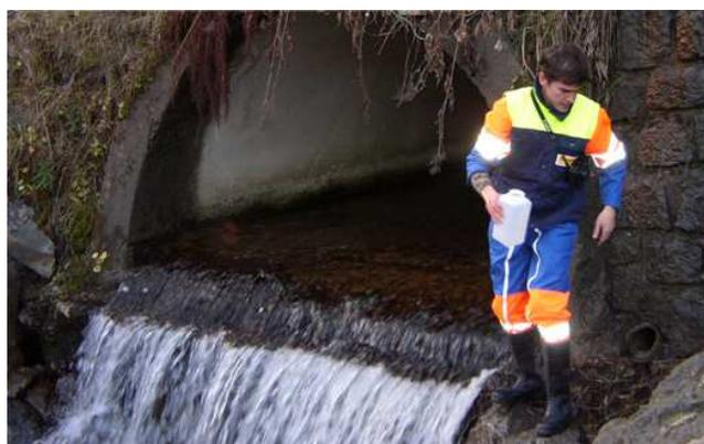
Prélèvement mensuel des eaux en amont et en aval du chantier pour analyse en laboratoire
