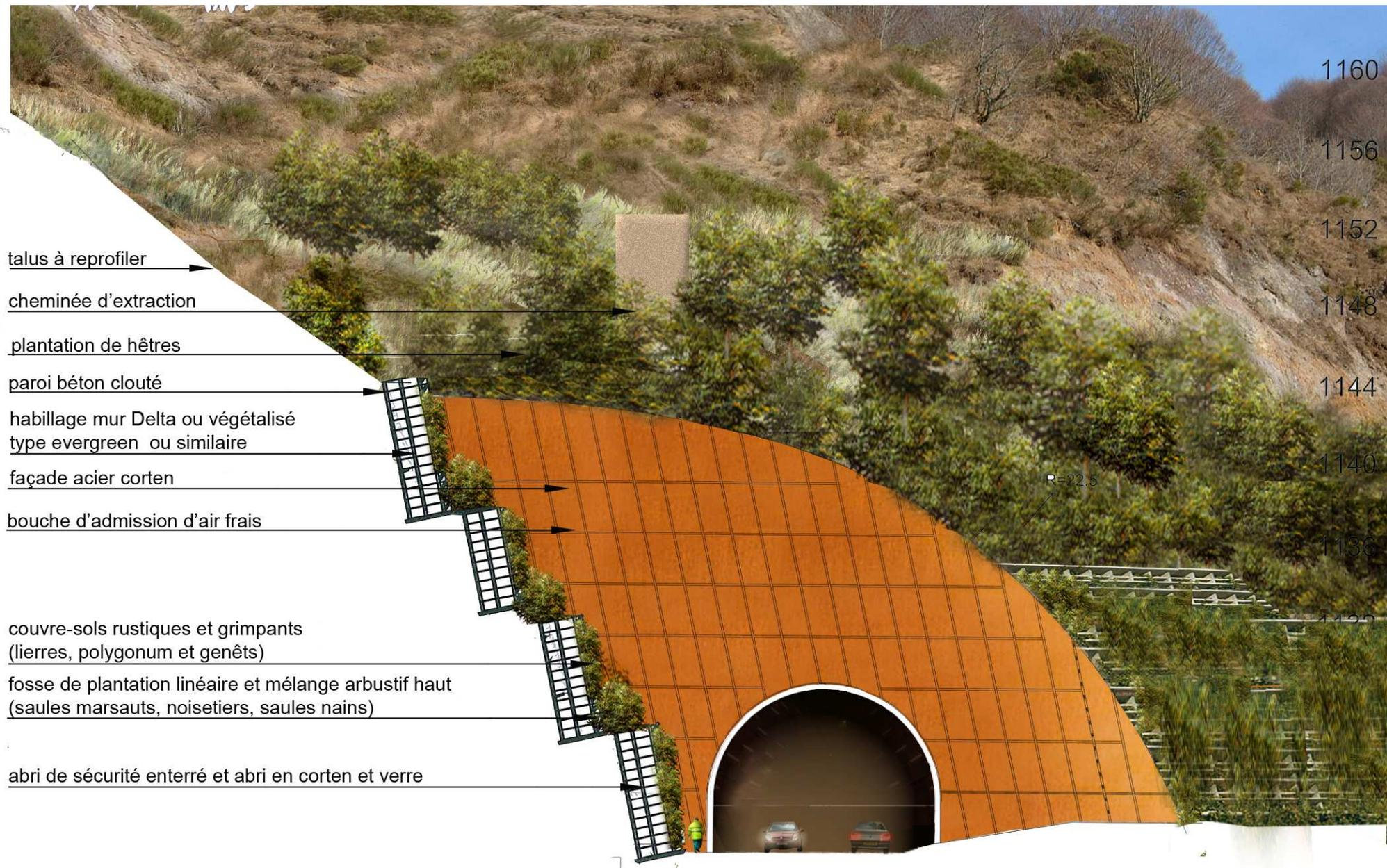
ELEVATION échelle 1/200 - Façade du tunnel côté Aurillac
